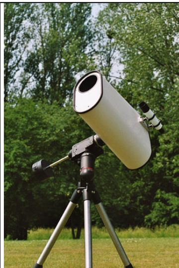
In dieser Position sollte das Gerät auf die Montierungsschiene aufgesetzt werden. Die Gegengewichtsachse inkl. der Gegengewichte zeigt ganz nach unten. Die Öffnung sollte dabei aber noch etwas tiefer gerichtet sein und das Gerät mit seiner Öffnung etwa zum Horizont zeigen.
